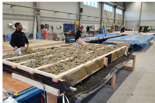
Skiveisolering "inne i" Posi-Joisten og kassetten fylles med løssull allerede i fabrikk.
