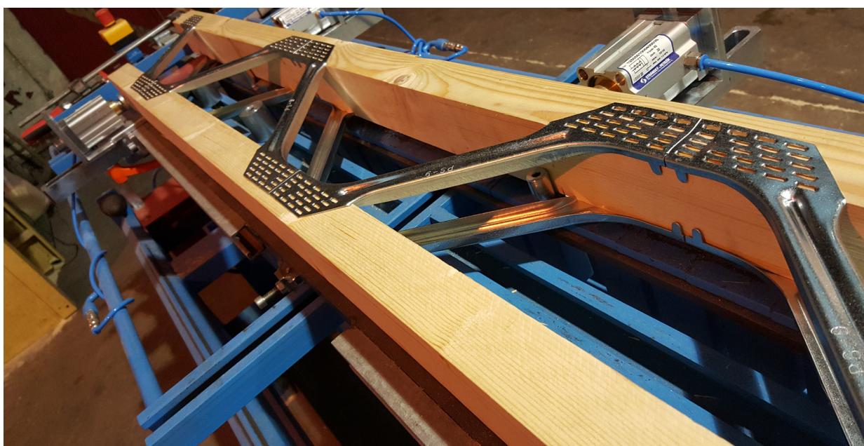
Posi-bjelker produseres i fabrikk hos Posi-produsenter og leveres prosjekttilpasset på byggeplass.
