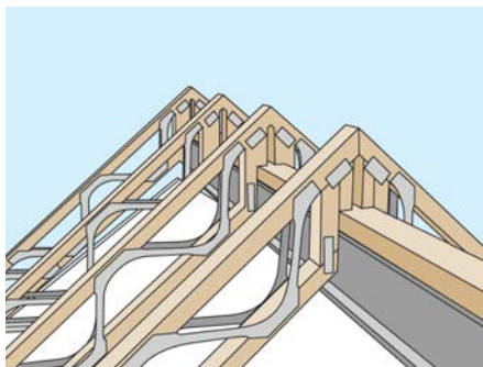
Endedetalj med spikerplate som har opplegg på stålbjelke i mønet.
