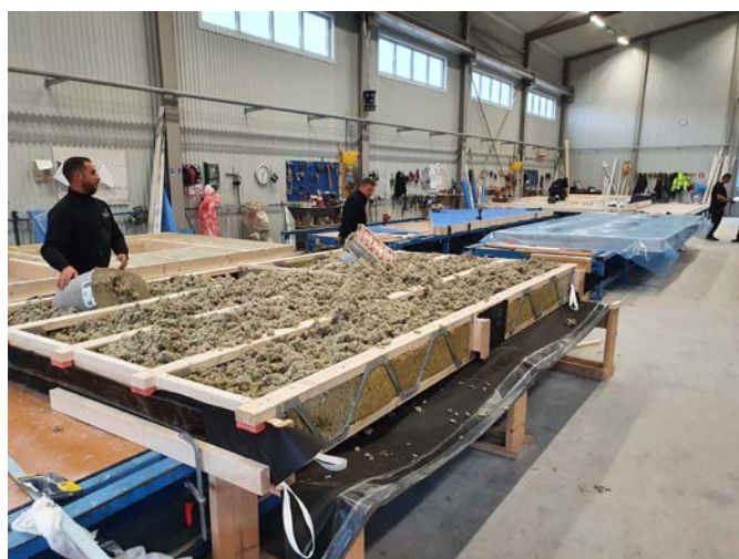
Skiveisolering "inne i" Posi-Joisten og kassetten fylles med løssull allerede i fabrikk.
