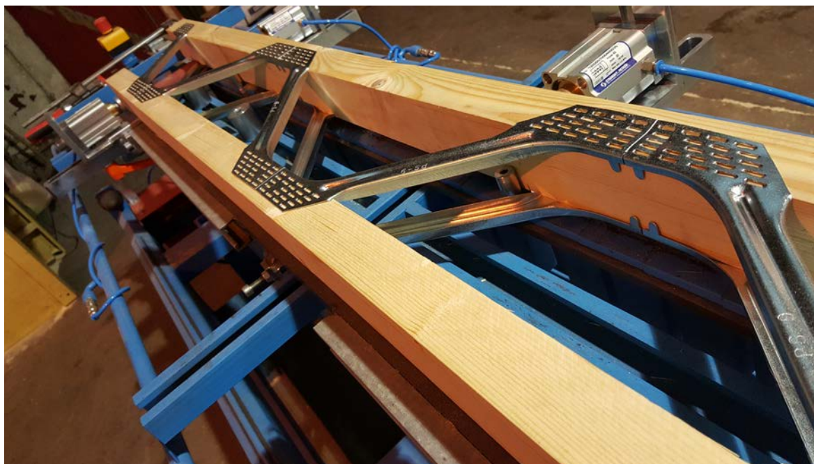
Posi-bjelker produseres i fabrikk hos Posi-produsenter og leveres prosjektilpasset på byggeplass.
